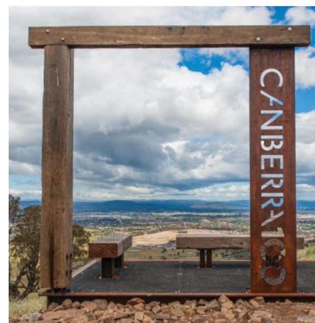
brána z dřevěného překladu s cortenem
